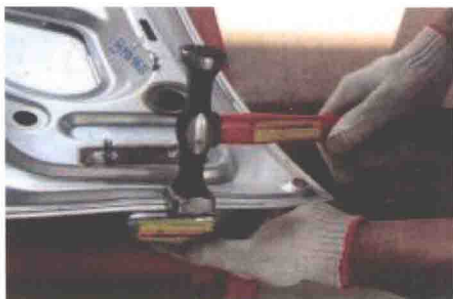
图 1-2 几种垫铁及垫铁的使用
