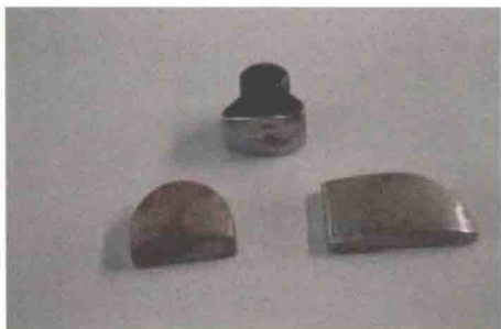
图 1-2 几种垫铁及垫铁的使用
