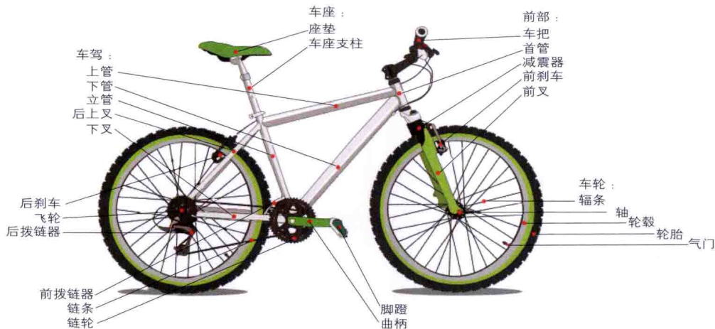
自行车结构图（作者 Fiestoforo）
