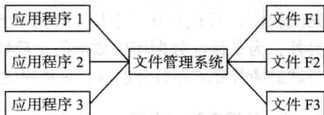
图 1-1 文件系统阶段程序与数据多多对应
