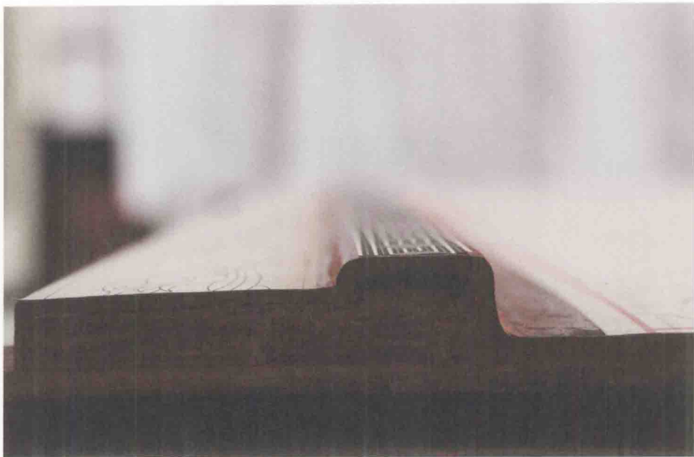
漆层髹涂到设计的厚度，雕刻就在这个漆层上进行
