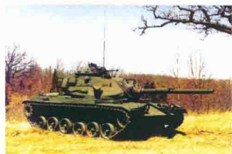
M60A3坦克配备有激光测距仪、电子模拟式弹道计算机、热成像瞄准镜和自动弹道传感器。这些配置提高了该型坦克的射击精度。
