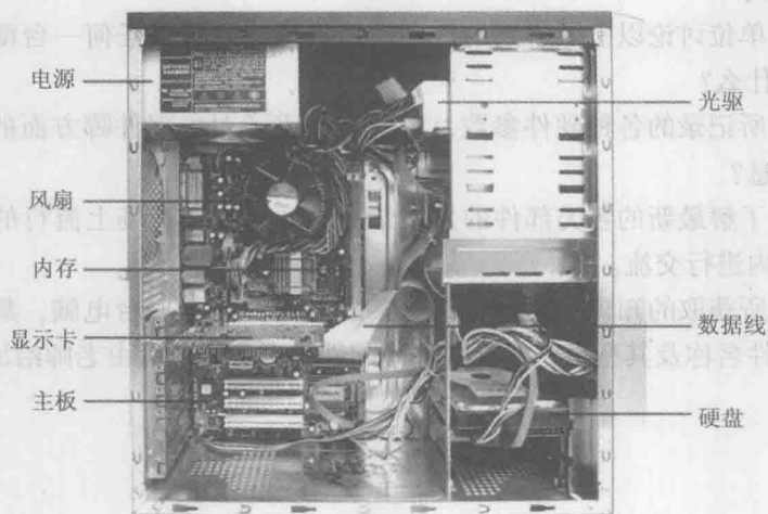
图 1-2 主机的内部结构
