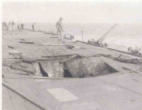
1945年2月21日“萨拉托加”号遭到日军的攻击，被日军战机命中5枚炸弹，前飞行甲板完全毁坏，在右舷炸出了两个大洞，并在飞机库引发了熊熊大火，阵亡和失踪者高达123名
