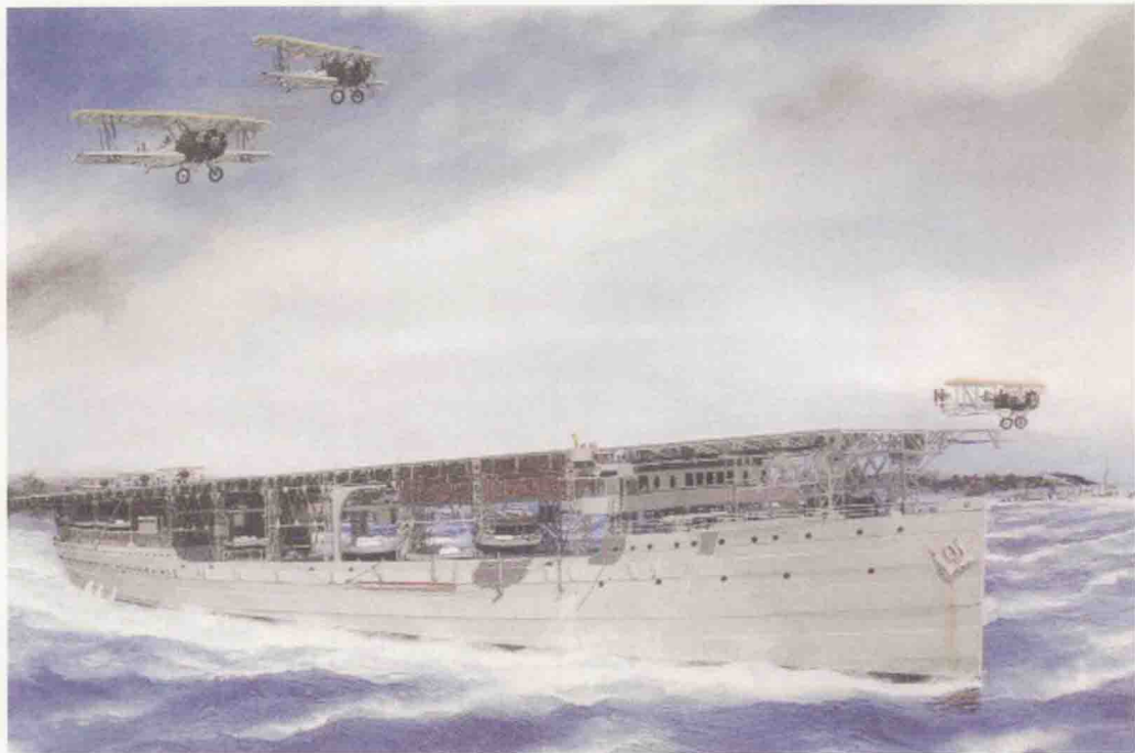
用煤船改装而成的“兰利”号航母只能进行有限的战术探索和试验，无法承担实际的作战任务
