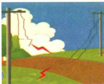
图 2-1 导线、电缆断落至地面
