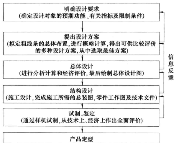
图 0-3 机械设计的一般过程
