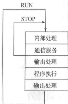
图 1-1-2 PLC 的工作过程
