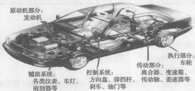
图 0-2 典型轿车构造图
