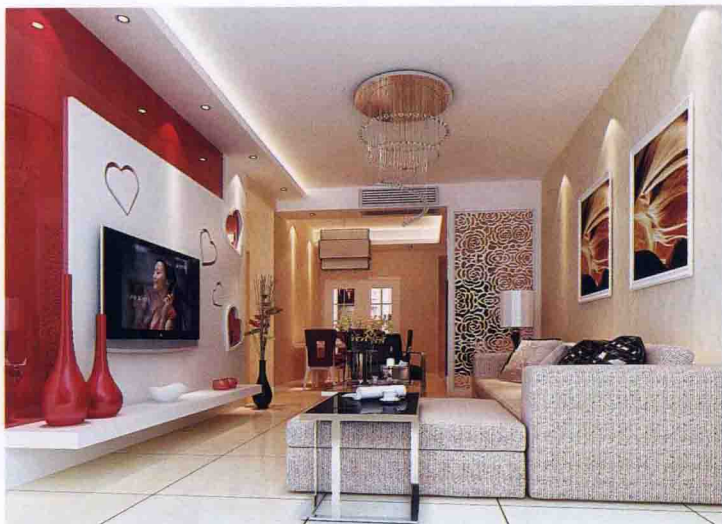
电视墙 [石膏板造型 + 烤漆玻璃]
