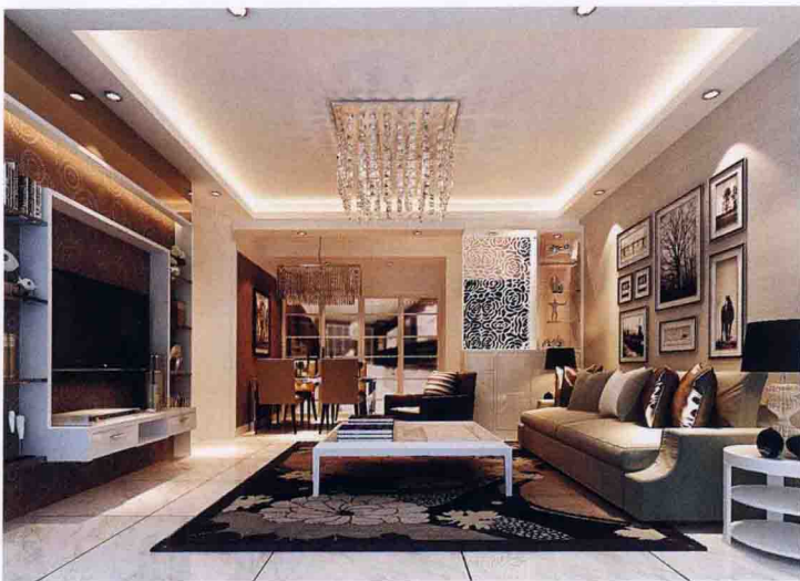
电视墙 [ 墙纸 + 饰面板装饰框刷白 + 玻璃搁板 + 茶镜 ]
