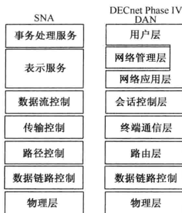
图 1-1 IBM 与 DEC 公司的计算机网络体系结构
