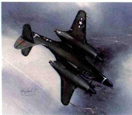
↑ 麦克唐纳公司的工程师用最新的飞机技术设计了双发的 XP-67 飞机，这些新技术包括一种先进的机体设计，并配备了一对不幸的、未经验证的、带涡轮增压的康特嫩特尔公司的 I-1430 发动机。该发动机被证明是设计的薄弱环节。
