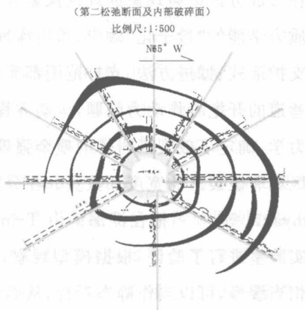
图 1.8 锦屏辅助洞东端 6-1#横通 洞断面松弛测试成果图
