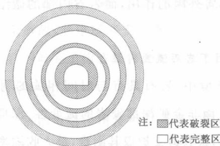
图 1.1 深部巷道围岩分区破裂现象示意图
