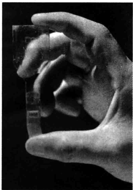
图 1-3 坩埚下降法首次突破完整云母单晶生长 (1965 年)
