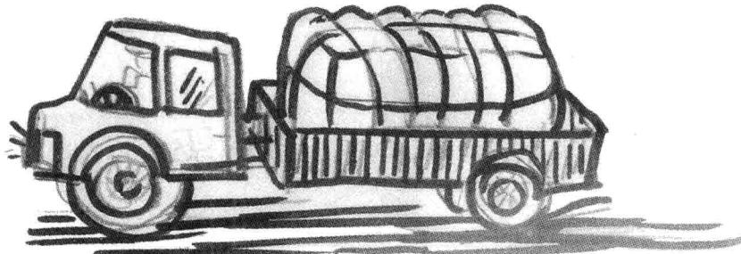
二、如果用前轮作驱动，那么前轮既要转向又要驱动，将汽车的驱动和方向机构合并在一起很复杂，驾驶员操纵方向盘比较麻烦也很费力，又不方便。所以，通常很少见到前轮驱动的载货车。
