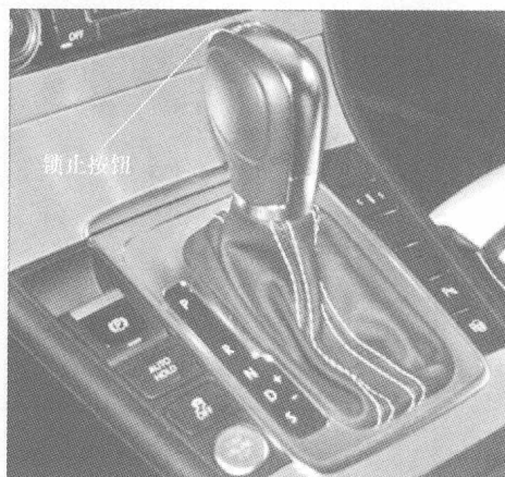
变速杆锁止按钮位置
