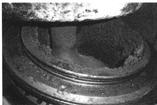
图 1-3 劣质燃油燃烧产物
