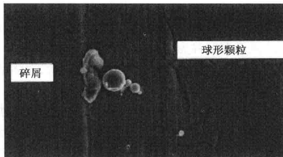
(b) 燃烧产生的金属颗粒附着在缸套上
