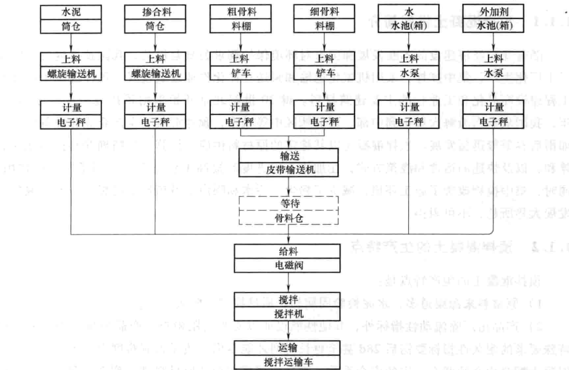
图 1-1 预拌混凝土生产工艺流程
