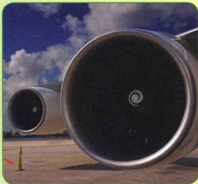
两台涡扇发动机安装在这架波音747飞机的机翼上。从这个角度可以看到喷气式发动机里面的扇叶。
