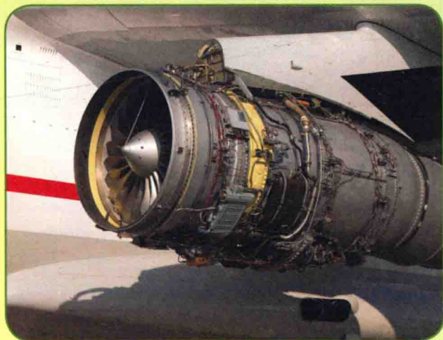
拆下外壳、正在维修的涡扇发动机
