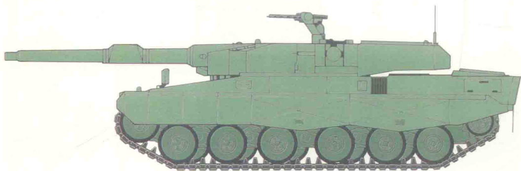
笔者粗绘的采用扁平炮塔和“欧洲动力组件”的坦克示意图
