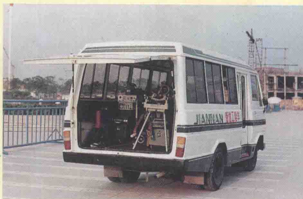
MYQ5030XGD 型管道工程车
