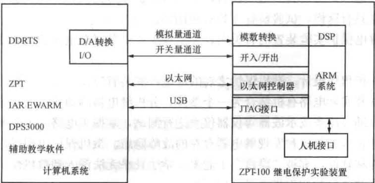
图 1-2 计算机和 ZPT-100 继电保护实验装置的连接
