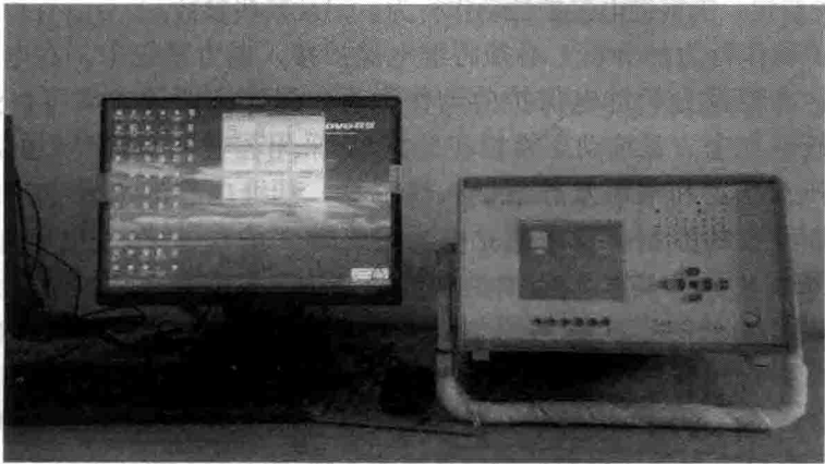
图 1-1 通用型继电保护实验系统硬件组成
