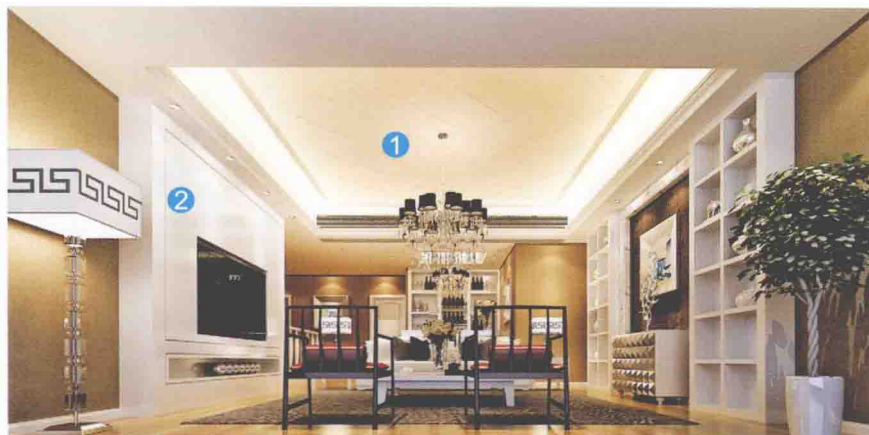
① 石膏板造型拓缝 ② 烤漆面板
