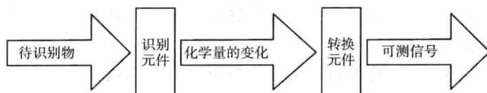
图 1-1 化学传感器原理示意图
