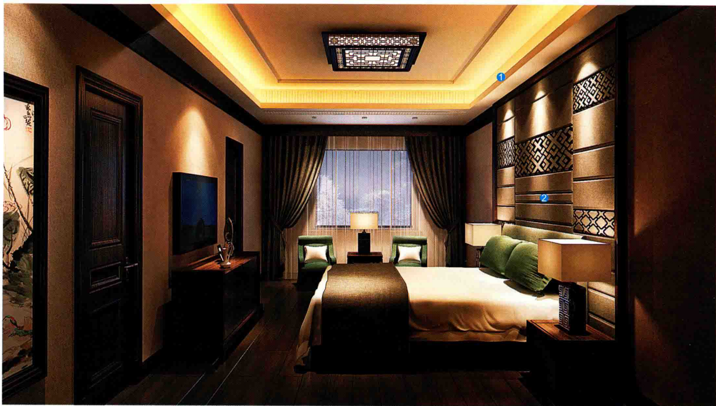
① 石膏板吊顶暗藏灯槽 ② 布艺软包
