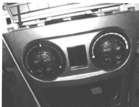
图 2-10 拆下空调控制器面板
