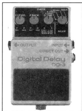
**延时有三个设置:** 设置延时反复次数的 FEED BACK; 设置原音与延时音之间间隔的 DELAY TIME; 用来控制延时音量调节的 LEVEL。
