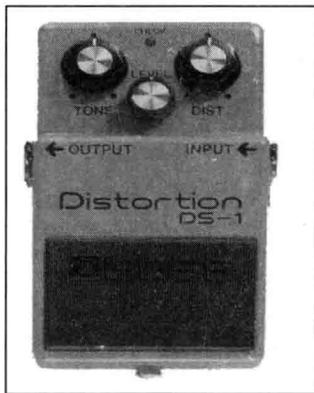
**失真有三个设置:**LEVEL 用来控制整个效果器音量的大小;TONE 可以对你所喜欢的音色进行全面的调整;DIST 用来调节失真度的大小，这个设置一般不宜开得太大以免产生过多的噪音。
