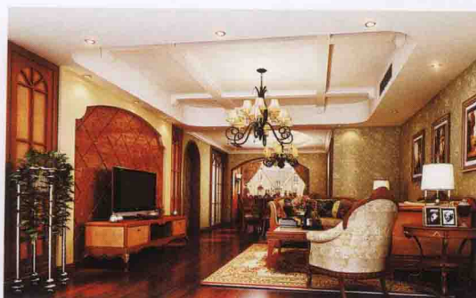
电视墙 [米黄大理石斜铺 + 彩色乳胶漆]
