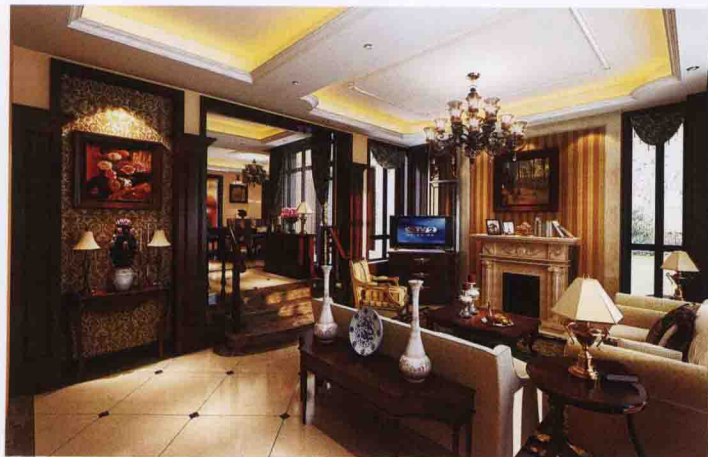
电视墙 [ 墙纸 + 大理石壁炉 ] 地面 [ 仿古砖夹深色小砖斜铺 ]
