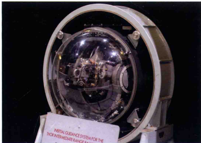
惯性制导系统的核心元件——陀螺仪
