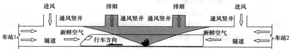
图 1-4 浅埋区间火灾自然通风排烟示意图
