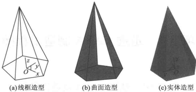
图 1-1-1 线框造型、曲面造型和实体造型
