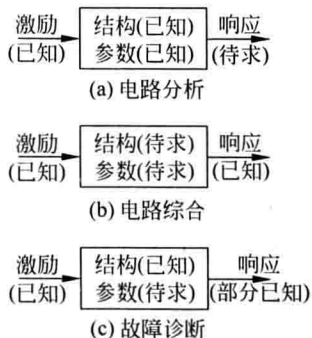
图 1-1 给出了电路分析、电路综合及故障诊断这 3 个研究 图 1-1 电路理论的 3 个分支
