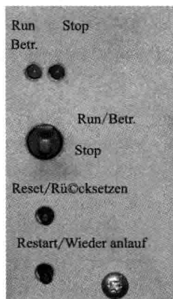
图 1-3 西门子 3 系统 130W/B CPU 模块上按钮与指示灯
