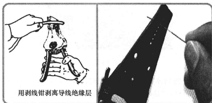
图 1-1-8 剥线钳的使用方法图解
