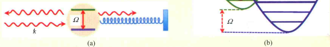
图 6 (a) 一维波导中波矢为 k 的光子被一维谐振子势阱中的二能级“原子”散射。“原子”跃迁频率为 \Omega ，谐振子频率为 \omega ，光子频率为 \omega_k ；(b) “原子”的能级结构由原来的两个能级劈裂成为距离为 \Omega 的两个边带。
