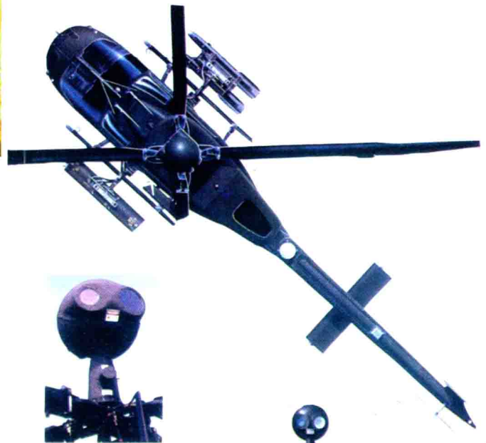
贝尔406直升机在旋翼轴瞄准具内装有电视摄像机、红外传感器和激光测距仪、座舱控制和显示系统、空战时的周期变距和总距操纵装置。
