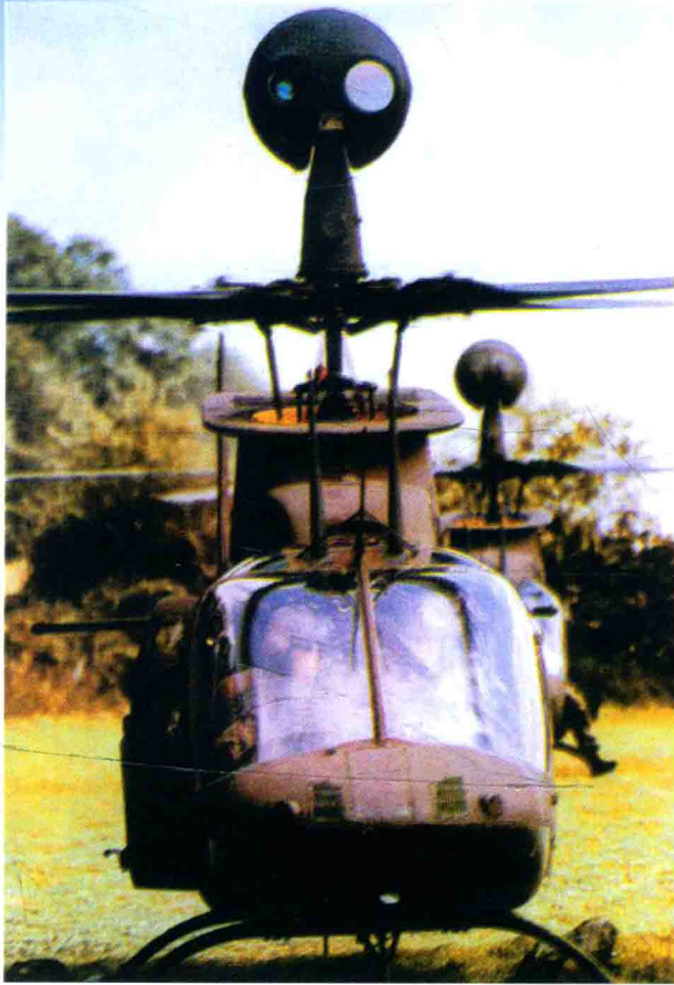
贝尔406直升机在旋翼轴瞄准具内装有电视摄像机、红外传感器和激光测距仪、座舱控制和显示系统、空战时的周期变距和总距操纵装置。
