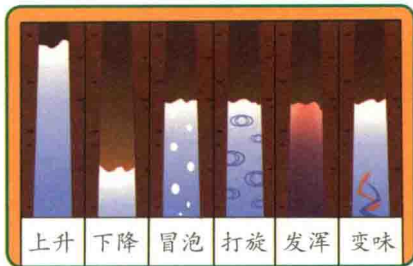
图1-2 地下水异常情况
