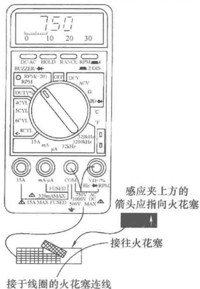
图 2-3 测量发动机转速
