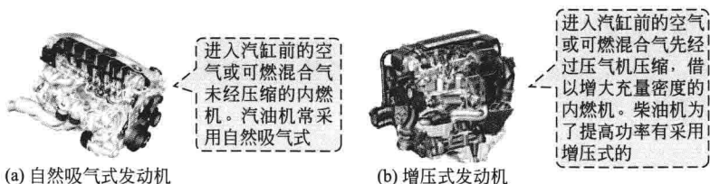
图 1-8 自然吸气(非增压)式发动机与强制进气(增压)式发动机
