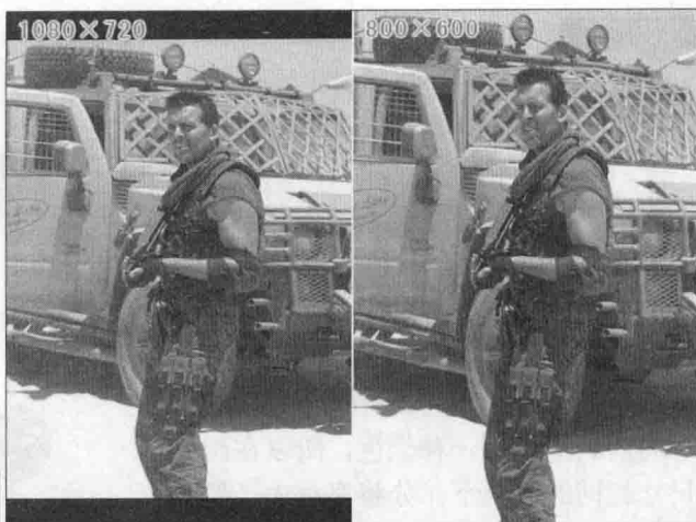
图 1-9 因像素宽高比不匹配而造成的画面变形
