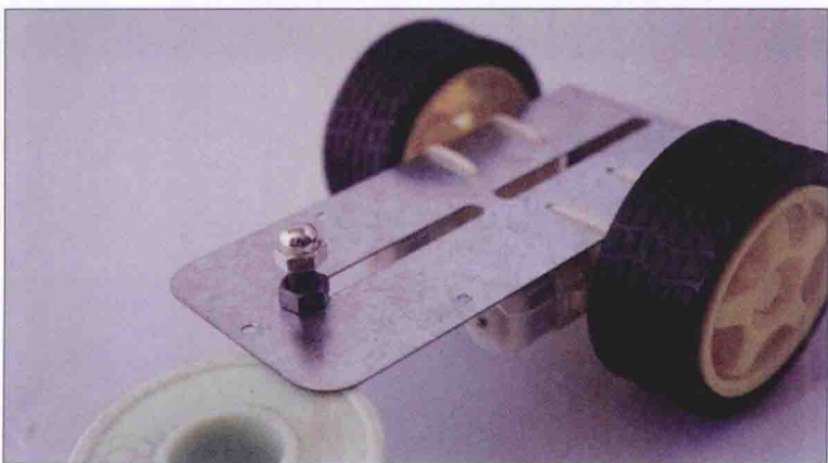
图1-7 车体底部视图。盖形螺帽安装在机器人前下方，起到支撑作用，它还是机器人的第3个轮子，相当于一个万向轮。调节盖形螺帽拧入M6螺丝的深浅，可以微调车体倾角（重心）
