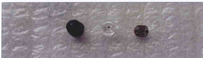
图1-9 3种常见的感光器件，从左往右依次为：5mm红外线接收管、5mm光敏二极管、光敏电阻
