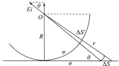
$$\text{对于无限大的平面, 有 } \sum \Delta s' = 2\pi R^2, \text{ 所以, } E = 2k\pi\sigma \text{ 或 } E = \frac{\sigma}{2\epsilon_0}$$
