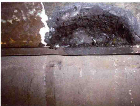
图4-23 某核电站凝汽器进出口管道腐蚀（97页）
