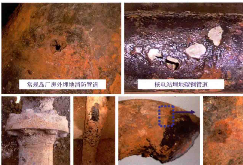
图4-39 埋地管线腐蚀形貌（100页）
