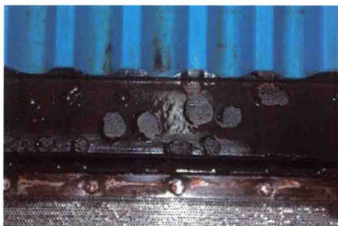
图4-18 国内某核电站旋转滤网腐蚀形貌（94页）
