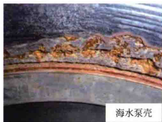
图4-22 某核电站核岛应急生水系统衬胶管道腐蚀穿孔（96页）
