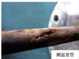
图4-22 某核电站核岛应急生水系统衬胶管道腐蚀穿孔（96页）
