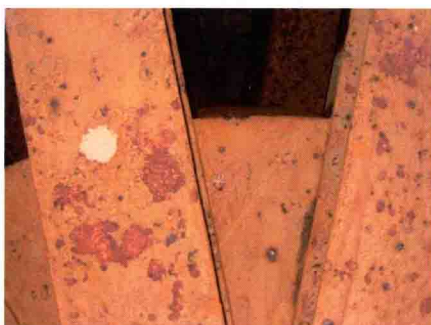
图4-18 国内某核电站旋转滤网腐蚀形貌（94页）
