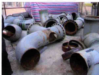
图4-30 SEC系统管道腐蚀形貌（98页）
