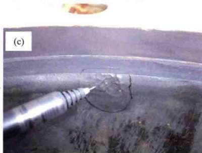
图4-22 某核电站核岛应急生水系统衬胶管道腐蚀穿孔（96页）
