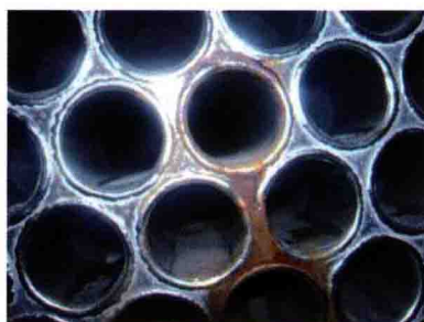
图4-32 凝汽器管板腐蚀（98页）
