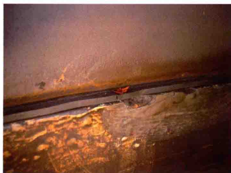
图4-23 某核电站凝汽器进出口管道腐蚀（97页）
