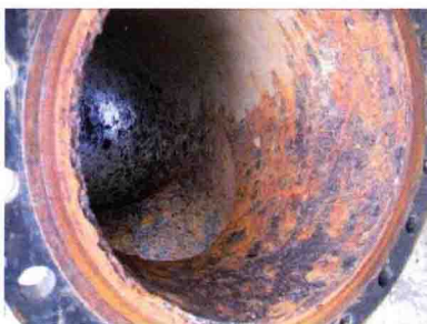
图4-30 SEC系统管道腐蚀形貌（98页）
