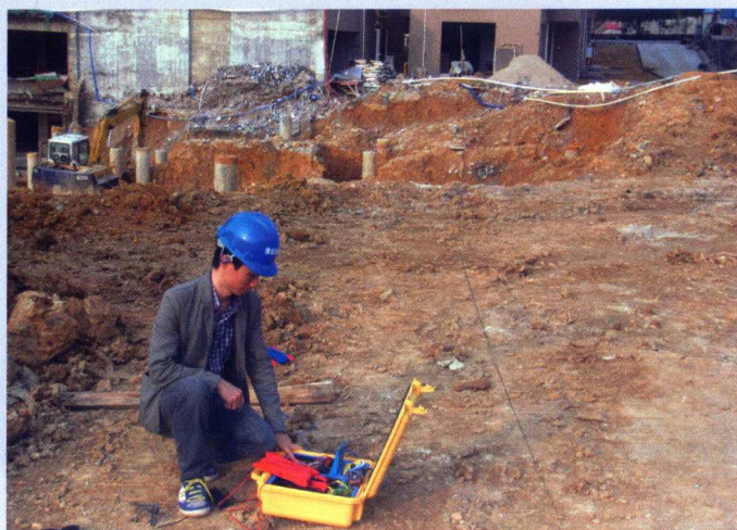
防雷检测人员对工地 防雷装置进行检测
