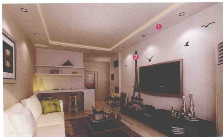
① 石膏板吊顶 ② 手绘墙饰
