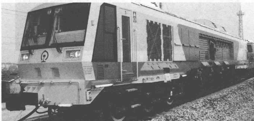
图 1-20 轨道铣磨机床(车辆)
