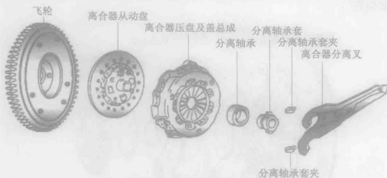
图 1.2 膜片弹簧式离合器的组成
