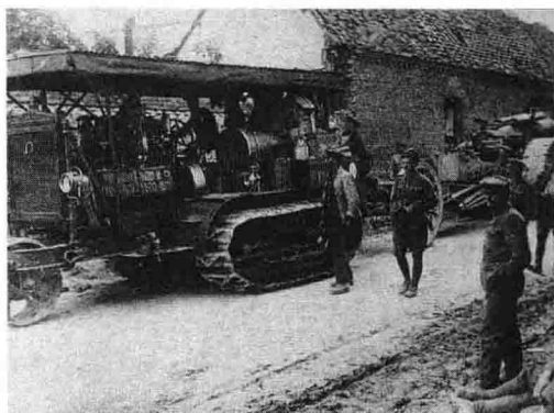
▲ 这种“霍尔特”拖拉机客串的军用牵引车可以成功地拉着重型装备顺利通过前方的泥泞道路
